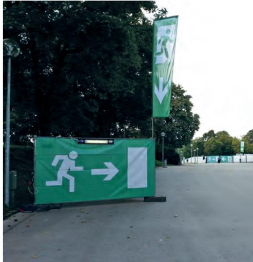
Abb. 30: Ergänzende Kennzeichnung eines Fluchtweges durch eines Flagge
