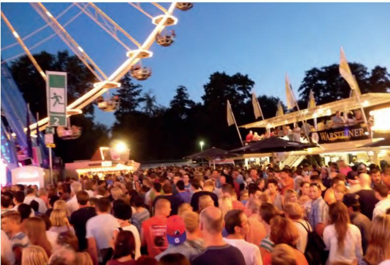
Abb. 31: Kennzeichnung eines Fluchtweges durch eine Flagge. Diese ist auch bei einer gut befüllten Veranstaltung sehr gut zu erkennen, da die Kennzeichnung nicht durch die Körper der Menschen verdeckt werden kann.
